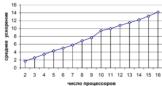
Рис. 2. Среднее ускорение для алгоритма параллельной генерации сочетаний, достигаемое при использовании 2, 3, ..., 16 процессоров
